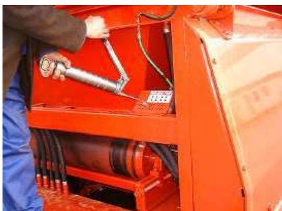
Aprire l'unità di comando e lubrificare tutti i punti del punto di lubrificazione centrale (usare lubrificante EP2-2 iniezioni per ogni punto di lubrificazione).
