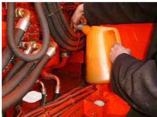
2:- Eseguire un rabbocco se necessario. (Fare riferimento al manuale del costruttore del motore per il tipo di olio da usare).
