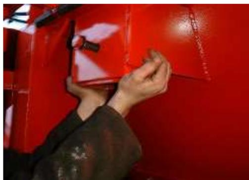
12:- Sollevare le gambe di sostegno della griglia e fermarle con le viti apposite per fissare l'angolo della griglia.
