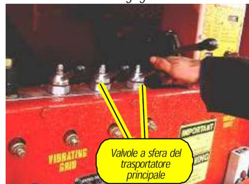
4:- Girare due valvole a sfera per azionare il trasportatore principale
