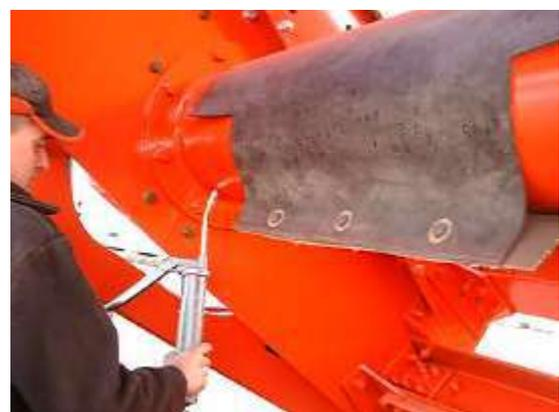
Lubrificare i cuscinetti dell'albero della vibrogriglia (usare lubrificante LGHQ3-4 iniezioni per ogni punto di lubrificazione).
