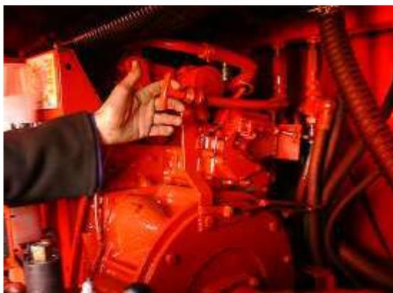
1:- Controllare il livello dell'olio nel motore.
