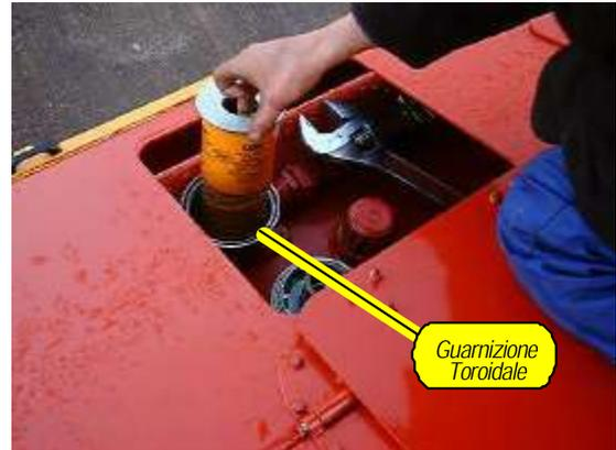
2:- Togliere l'elemento filtrante vecchio e sostituirlo con uno nuovo. Prima di rimettere a posto il tappo del filtro assicurarsi di aver rimontato la guarnizione toroidale.
