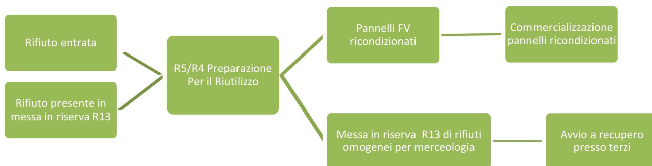
Figura 9 - Schema gestione rifiuti sottoposti all’operazione di scambio di rifiuti R5/R4.
