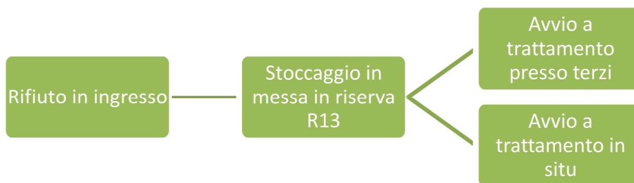
Figura 6 - Schema gestione rifiuti sottoposti alla messa in riserva R13
