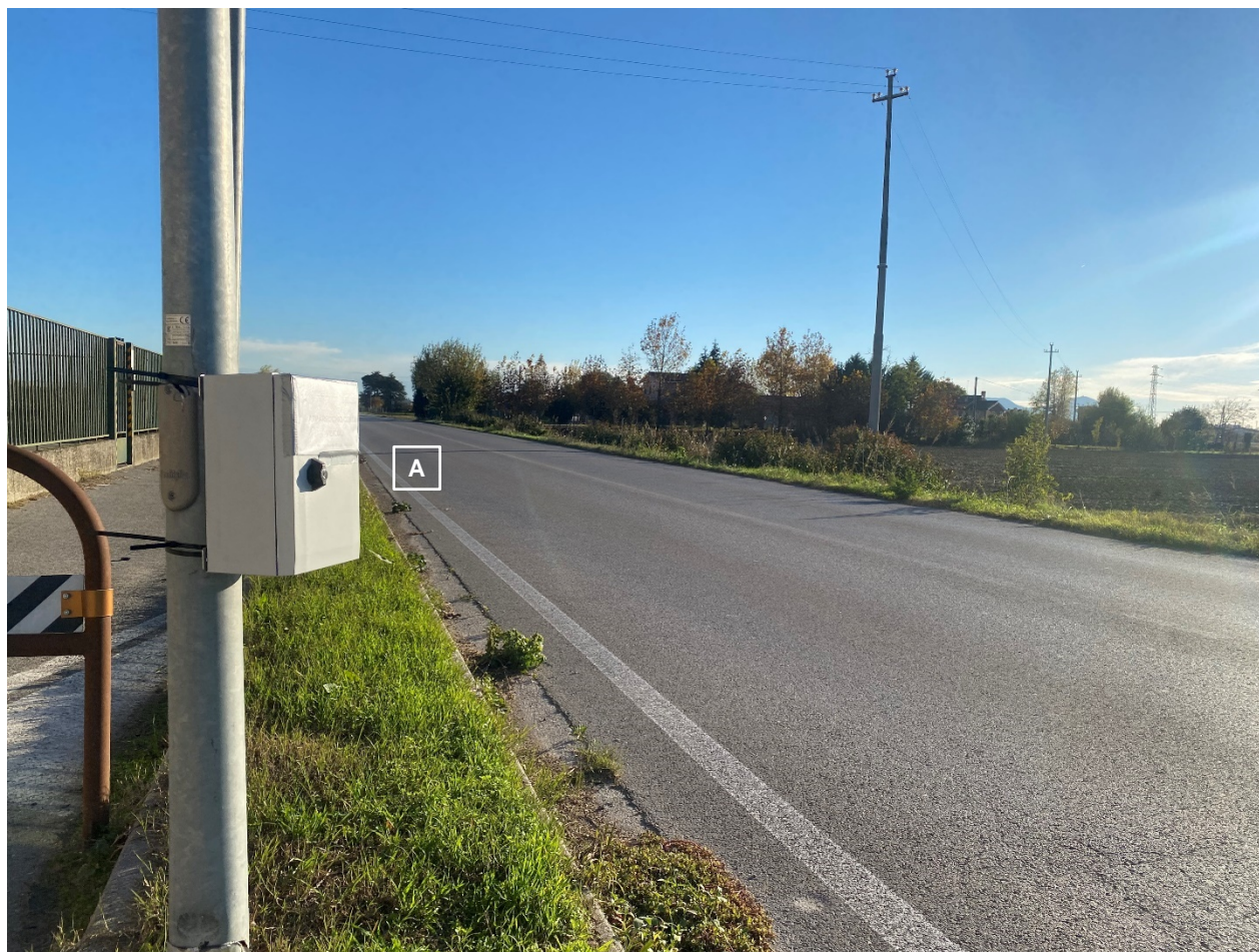
Figura 3.2 – Foto del radar utilizzato per il rilievo automatico ed installazione del medesimo lungo la SP 46
