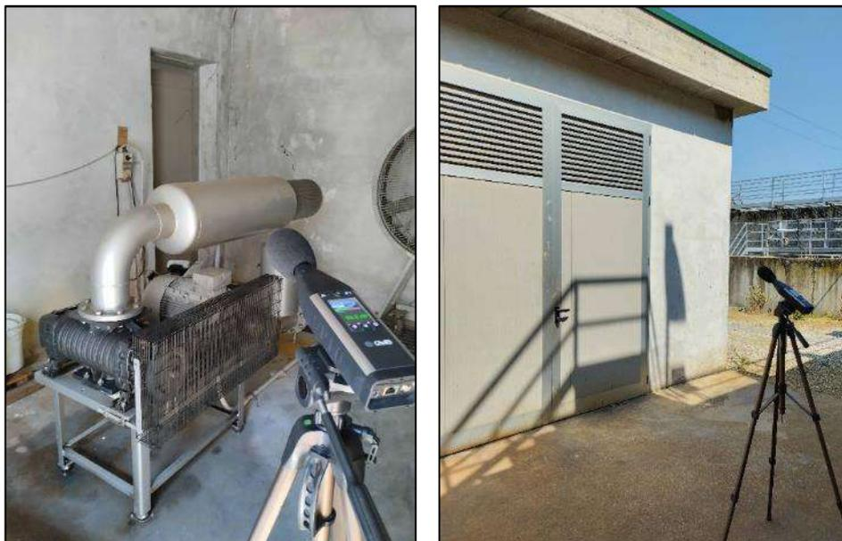
Durante i rilievi per la caratterizzazione delle sorgenti, è stato effettuato un rilievo interno al locale ed un rilievo esterno a 2 m dal portone metallico. Sono di seguito riportati risultati dei rilievi:
