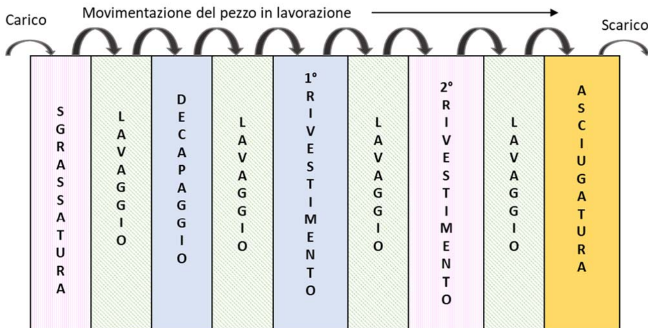
Figura 5: Linea di processo semplificata
