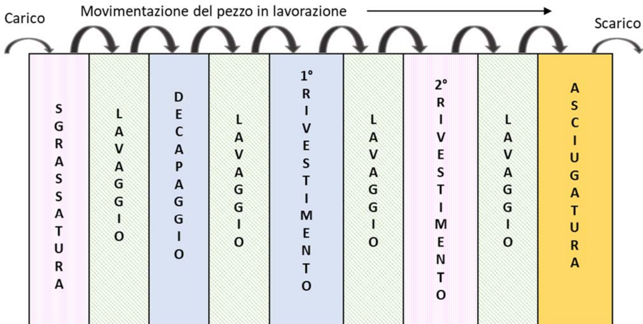
Figura 5: Linea di processo semplificata
