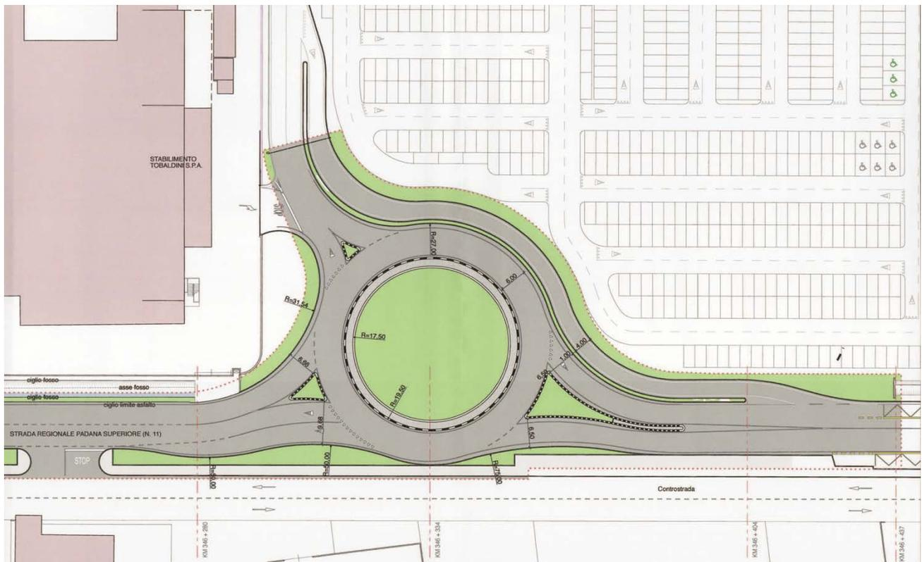
**Figura 1.6 - Planimetria dell'intersezione a rotatoria presente all'angolo sud-est del lotto che ospita la sede operativa della ditta**
