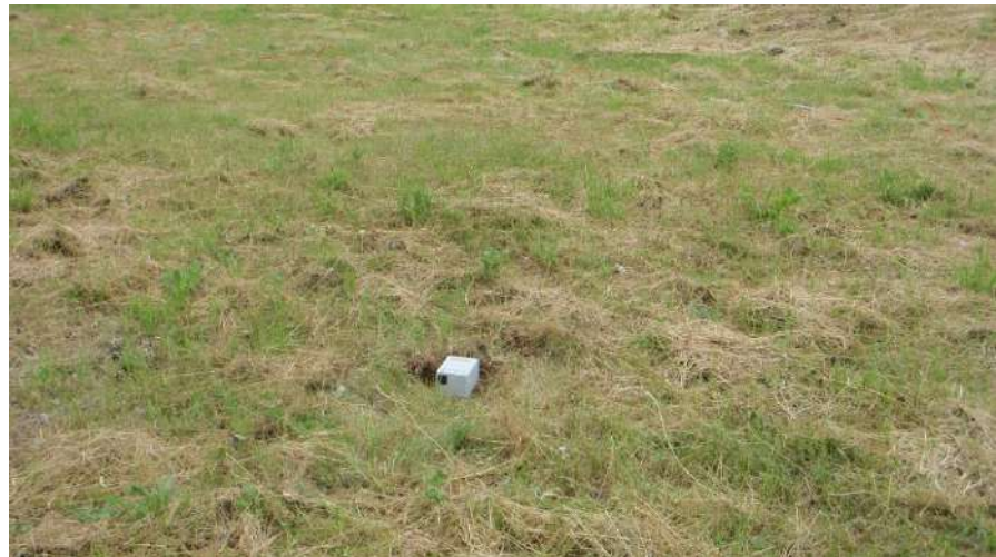
Esecuzione Indagine Sismica Passiva (HVSR)
