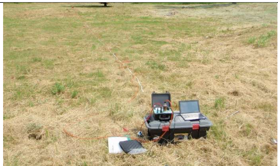
Esecuzione Stendimento Sismico Attivo (MASW) e passivo (Re.Mi.)
