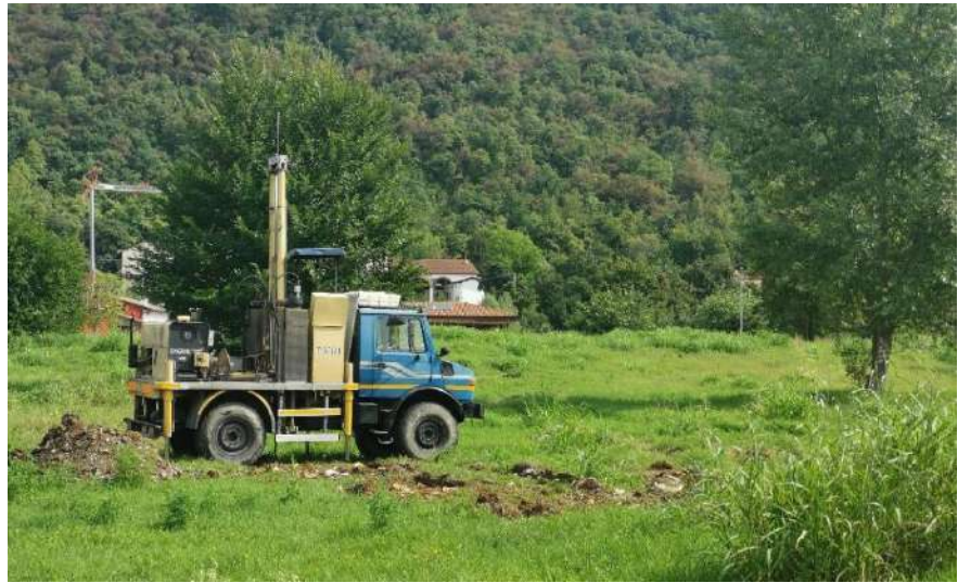
Prova Penetrometrica Dinamica Superpesante (DPSH)
