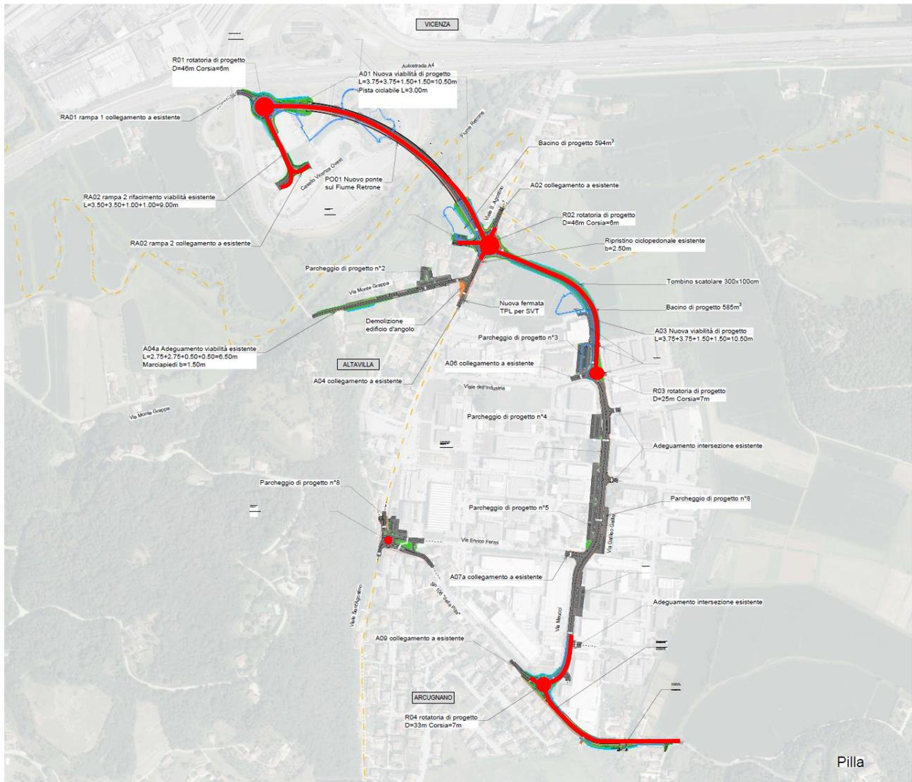
Figura 1: Rappresentazione degli interventi di progetto con indicati in rosso tutti gli interventi che prevedono il rifacimento completo del pacchetto stradale (pari a massimo 44 cm circa), tutte le restanti aree (in grigio) prevedono la sola risistemazione della viabilità esistente (rifacimento dei soli strati bitumati)
