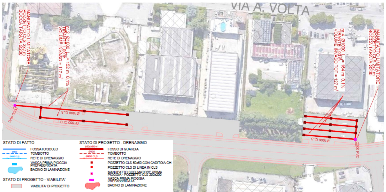
Figura 26 sistemi per la laminazione nei due parcheggi di progetto lungo la viabilità AS03
