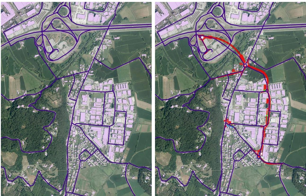
**Figura 4 Rete stradale attuale (a sinistra) e con il progetto di variante (a destra)**
