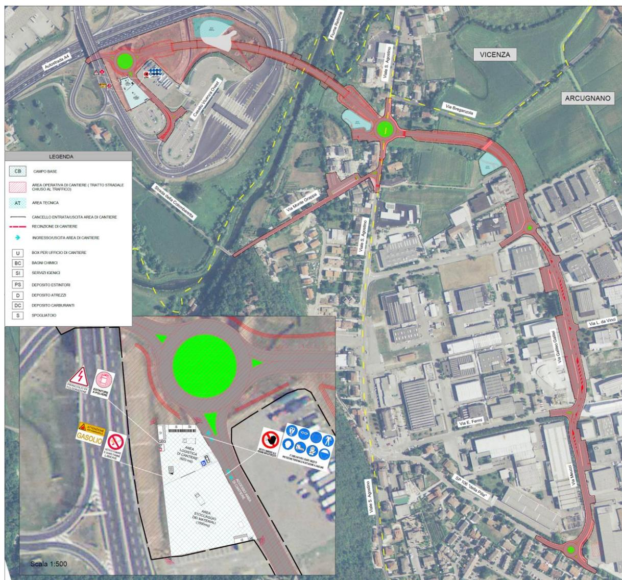
**Figura 24** Planimetria generale di progetto con individuazione delle aree di cantiere
