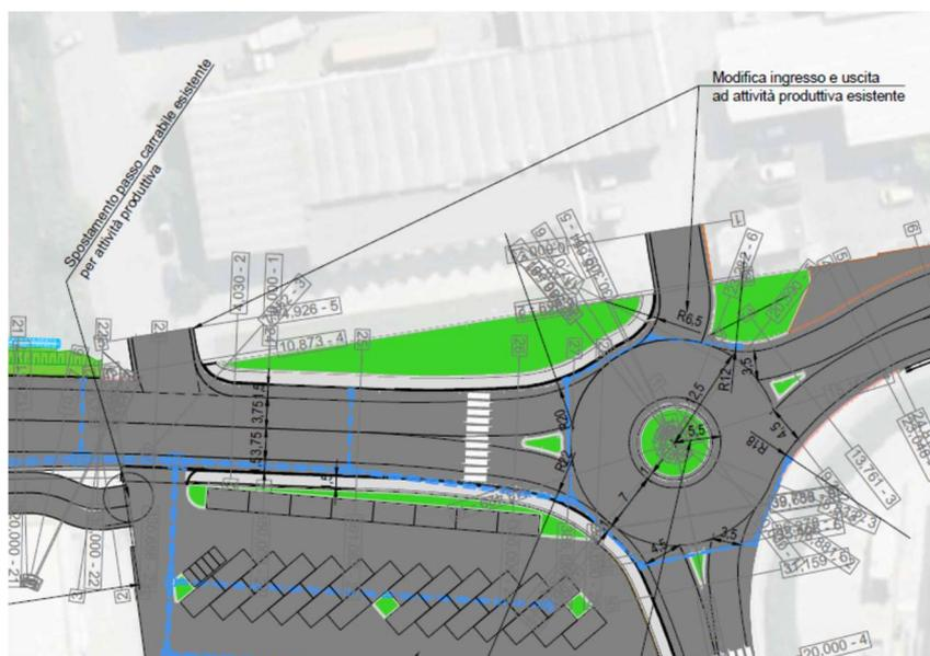
Figura 24 Riconfigurazione ingresso e uscita civico 1
