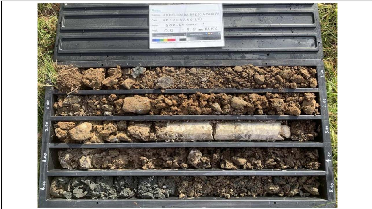
SONDAGGIO n° S02-DH DATA 10/11/2021 CASSA n° 2 PROFONDITA' DA m 5.00 A m 10.00
