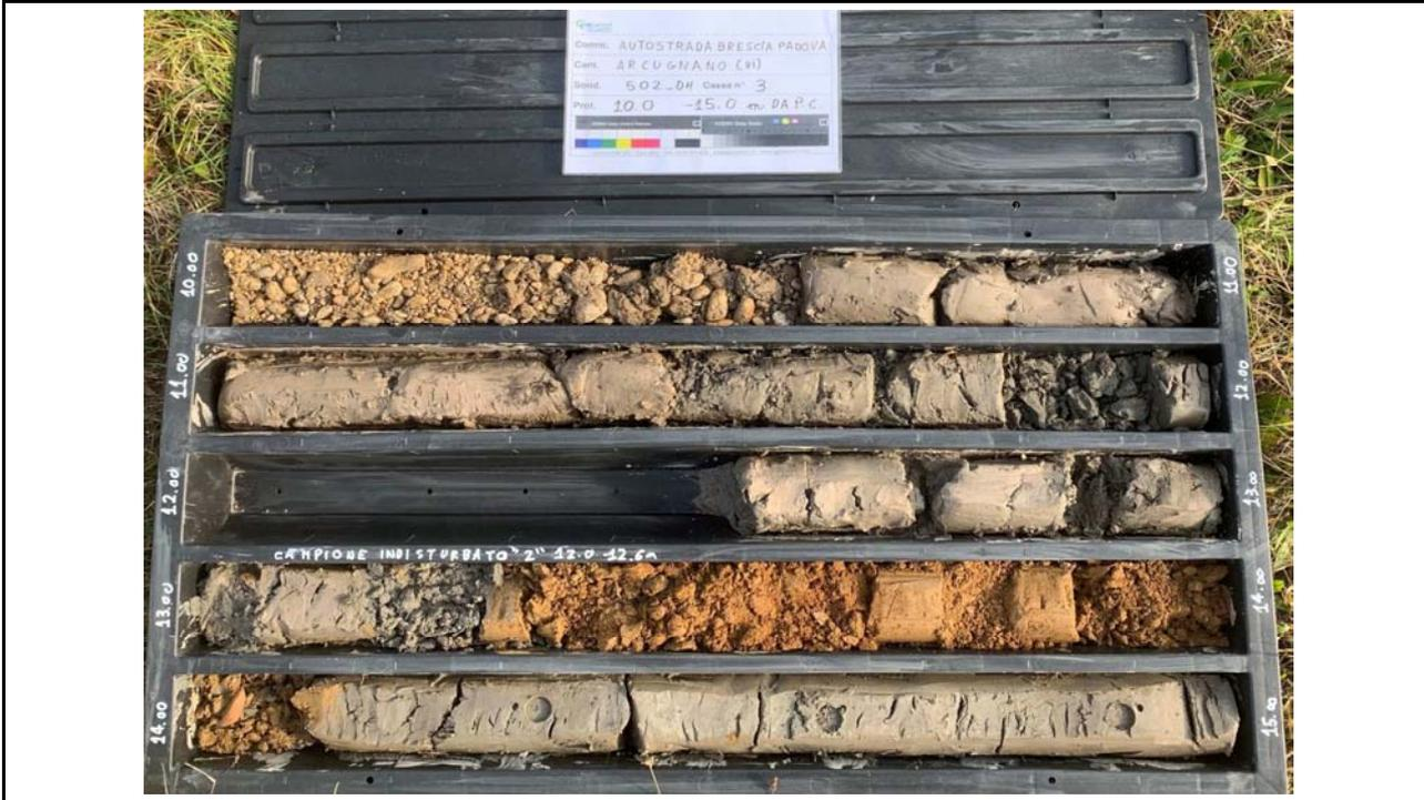
SONDAGGIO n° S02-DH DATA 11/11/2021 CASSA n° 4 PROFONDITA' DA m 15.00 A m 20.00
