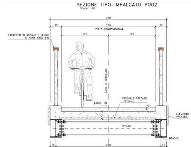
Figura – Ponte ciclopedonale sullo scolo Cordano– Sezione tipo.
