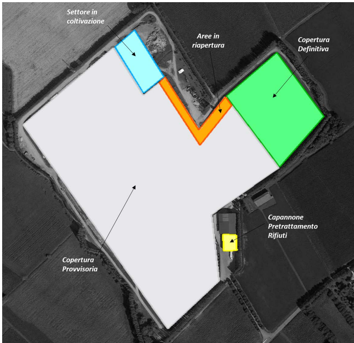
Potenziali sorgenti emissive (esempio)
