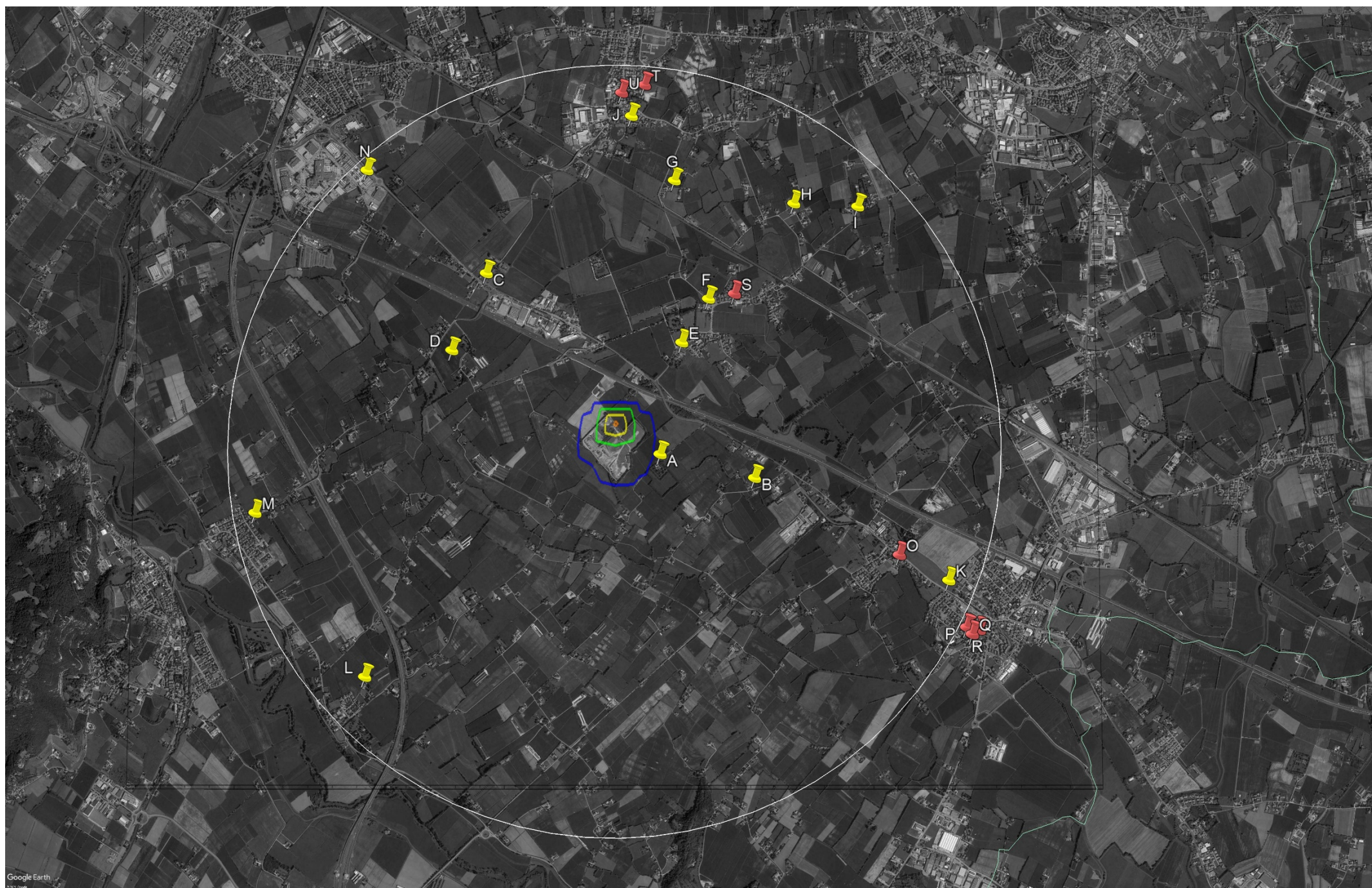
Stato di fatto - Mappa d'impatto odorigeno. Isopleta blu = 1 \text{ OU}_E/\text{m}^3 , isopleta verde = 2 \text{ OU}_E/\text{m}^3 , isopleta gialla = 3 \text{ OU}_E/\text{m}^3 , isopleta arancione = 4 \text{ OU}_E/\text{m}^3
