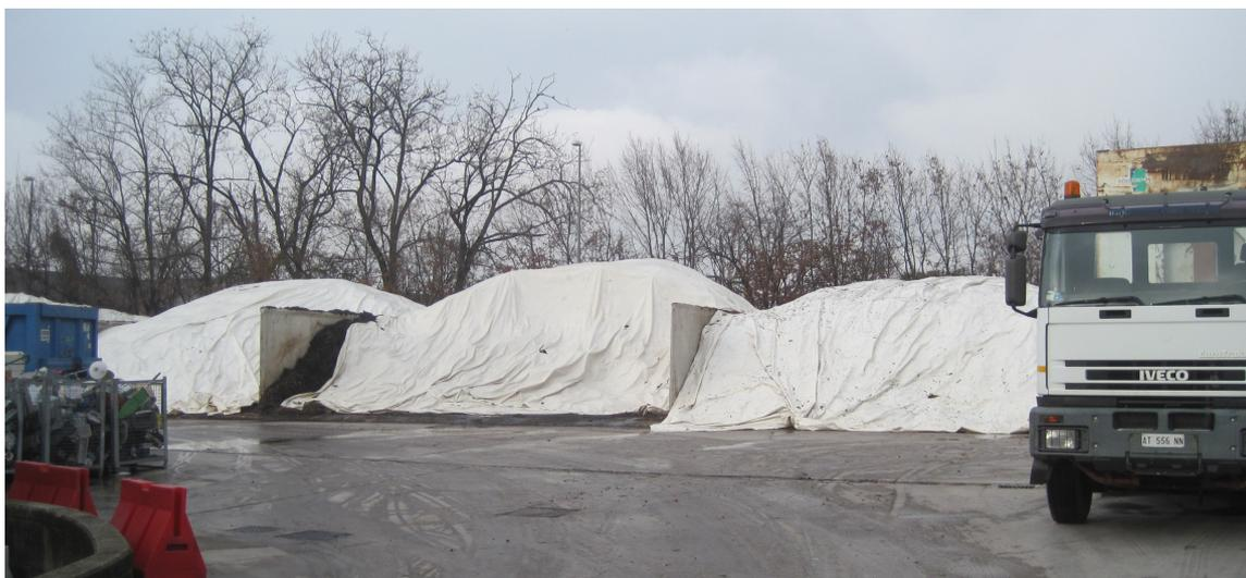
**Figura 3-8: Silos per lo stoccaggio dei materiali ligneo-cellulosici coperti mediante teli mobili.**
