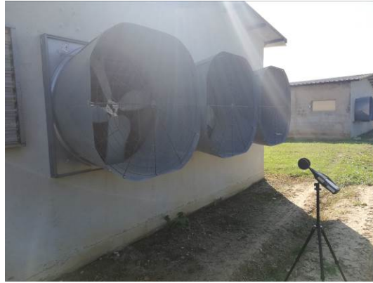
Foto n.1 : fase di misura del livello di pressione sonora di un singolo ventilatore
