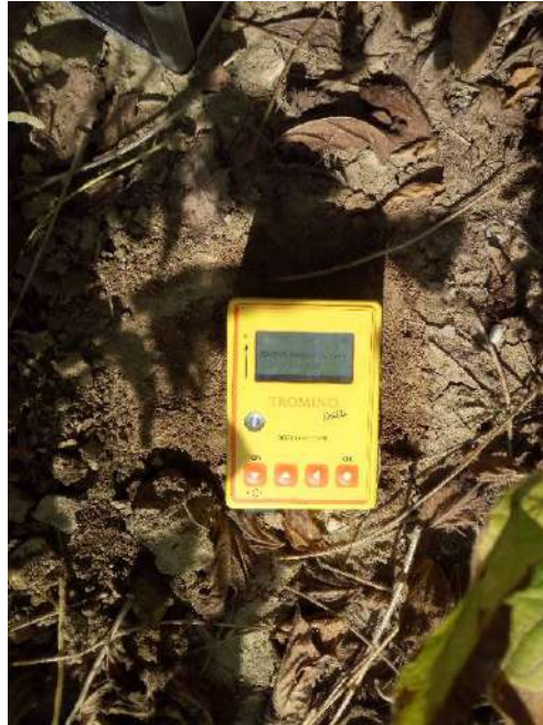
Sismografo triassiale in dotazione con sensori ortogonali da 4,5 Hz e convertitore A/D 24 bit
