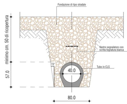
**SEZIONE TUBO Ø 400 mm**
