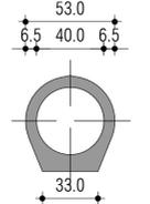
**POZZETTO D'ISPEZIONE FOGNATURA BIANCA**
