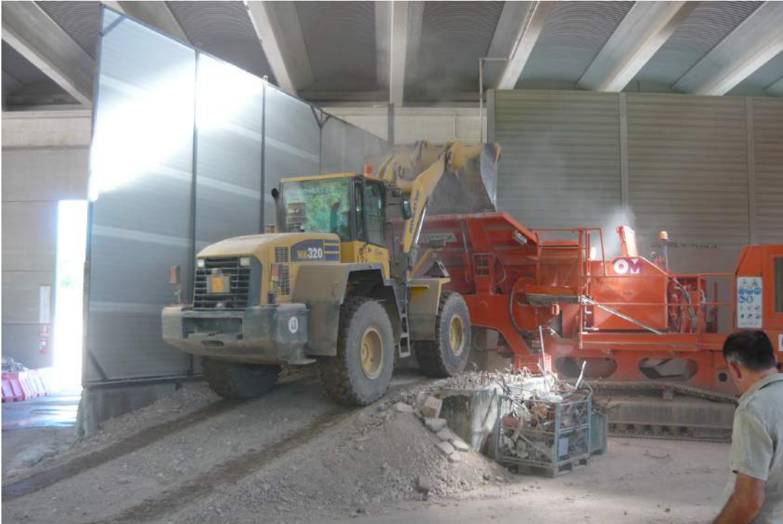
Foto 13- Area di carico frantoio Ulisse, con barriera fonoisolante realizzata internamente al capannone, per mascherare l'emissione acustica verso il lato ovest (aperto) del capannone
