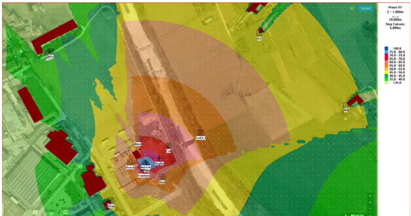
Figura 14: Modello di propagazione con frantoio in funzione e presenza di pala ed autocarro.
