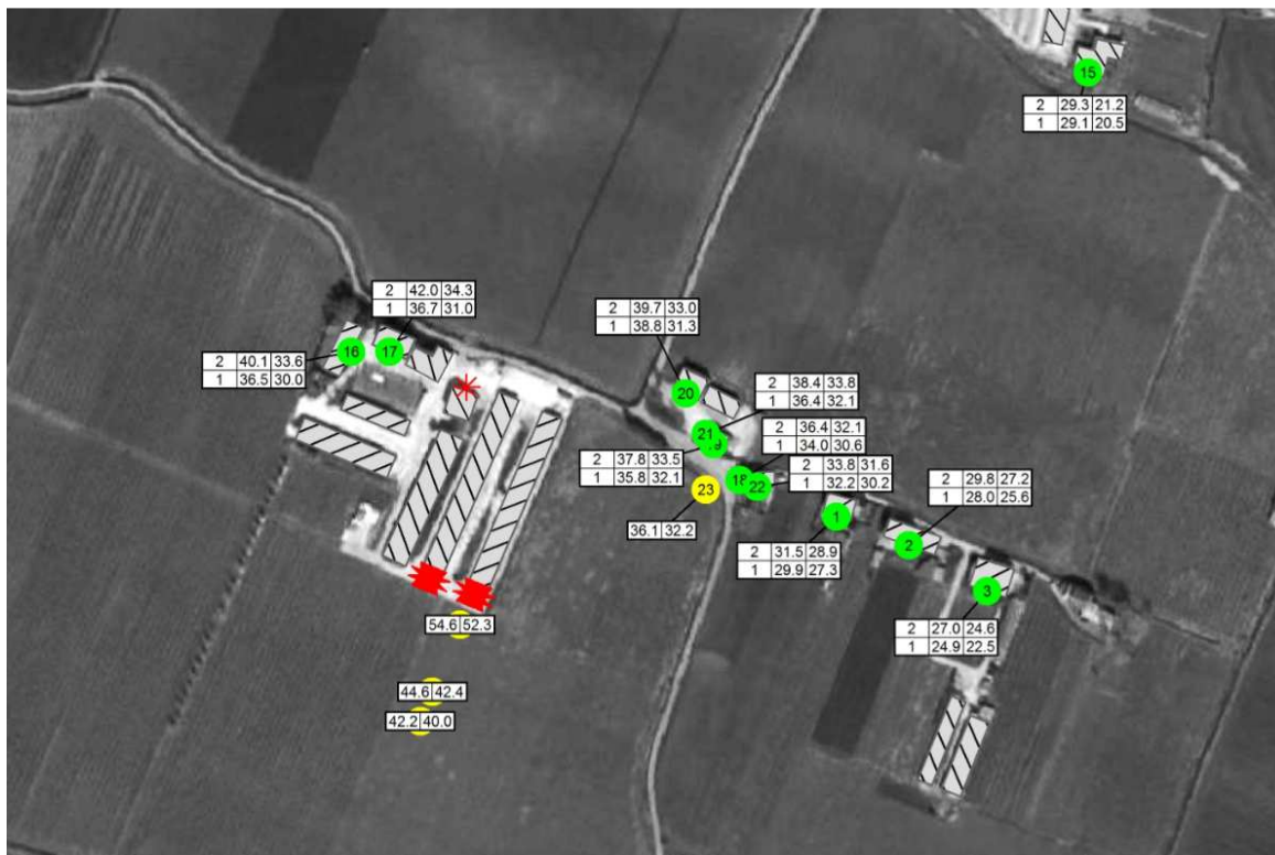
Mapa con indicazione punti di taratura del modello presso REC1 in periodo notturno (punti in giallo)
