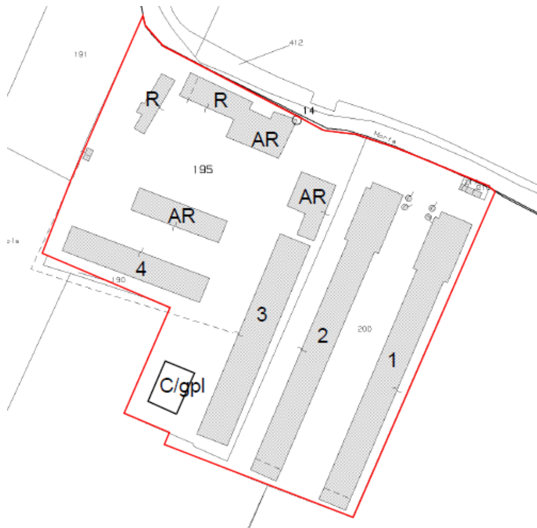
Disposizione dei capannoni post intervento
