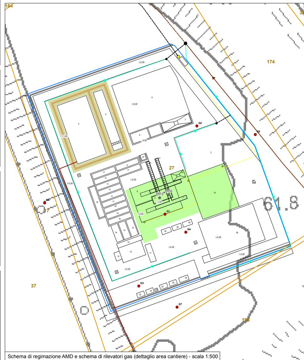
Schema di regimazione AMD e schema di rilevatori gas (dettaglio area cantiere) - scala 1:500
