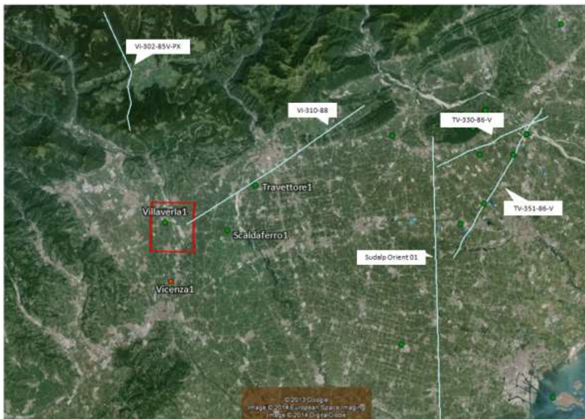
Fig. 39. Localizzazione dei pozzi per l'esplorazione petrolifera (cerchio verde) e geotermica (cerchio rosso) e linee sismiche (linee azzurre) eseguiti in prossimità del P.R. Montecchio Precalcino (quadrato rosso).
