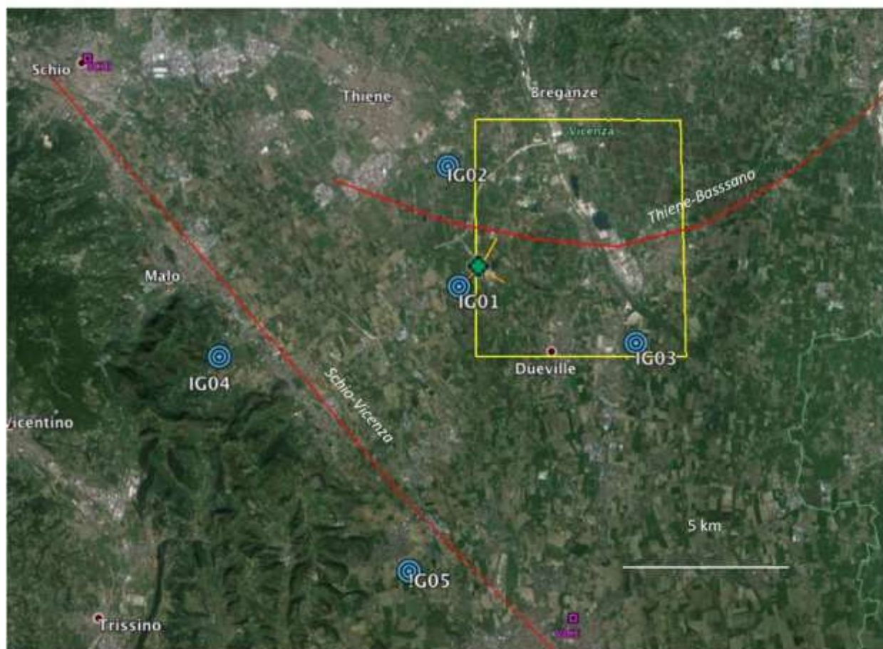
Fig. 14 - Disposizione delle stazioni prevista per la Rete Sismica di Montecchio Precalcino, a scala locale. I simboli rappresentano: quelli rotondi azzurri le stazioni della rete proposta (sigla IG), il rombo verde la posizione dei pozzi con le due deviazioni orizzontali in profondità (segmenti arancio), il rettangolo giallo i limiti della concessione, la linea bianca in basso la distanza di 5 km. Le due linee rosse rappresentano il sistema Schio-Vicenza (a Sud-Ovest) ed il sistema Thiene-Bassano (a Nord-Est), come da consultazione della banca dati dell'INGV e pubblicazioni scientifiche. I simboli piccoli colore magenta, rappresentano le posizioni delle stazioni GPS permanenti del Veneto già presenti nell'area.
