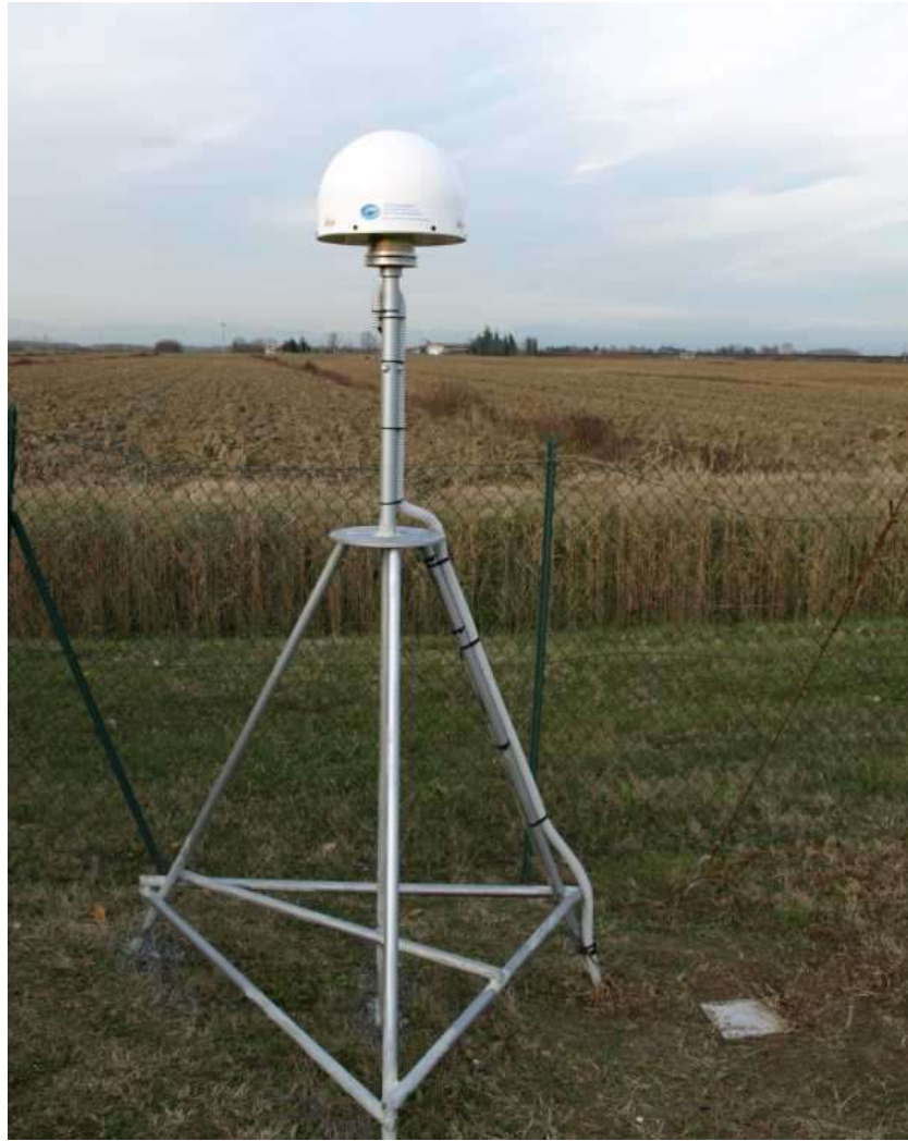
Fig. 13 - Monumento per l'antenna GNSS proposto in questo progetto nel caso di terreni poco consolidati. L'immagine raffigura il monumento della stazione PAZO della rete FreDNet.
