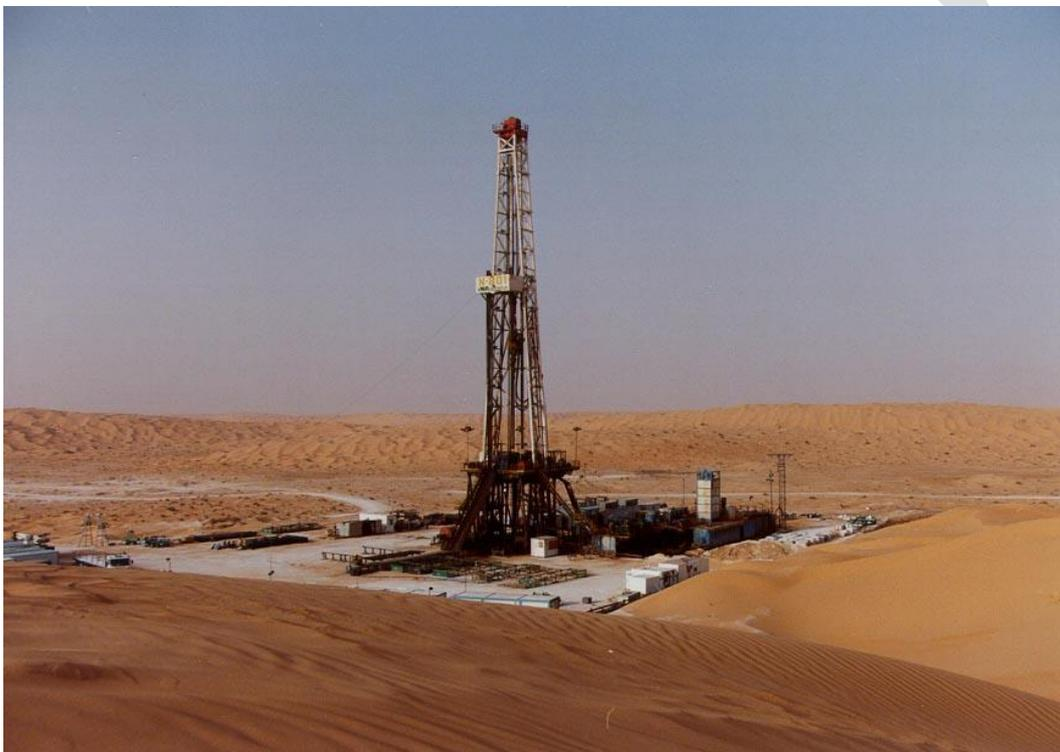
Fig. 3 – Disposizione tipica di un impianto di perforazione N 801
