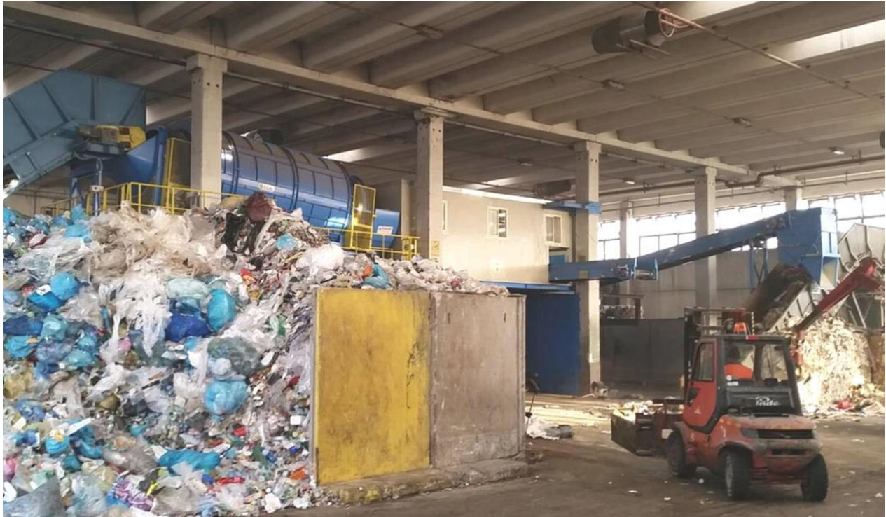
Foto 4. Panoramica dell'impianto: sullo sfondo nastro trasportatore pressa imballatrice.
