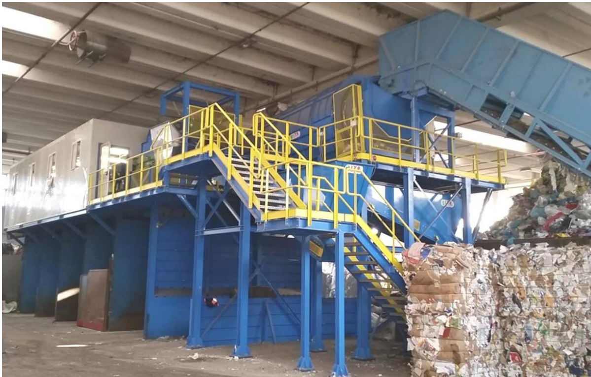
Foto 1. Linea di selezione e riduzione volumetrica.
