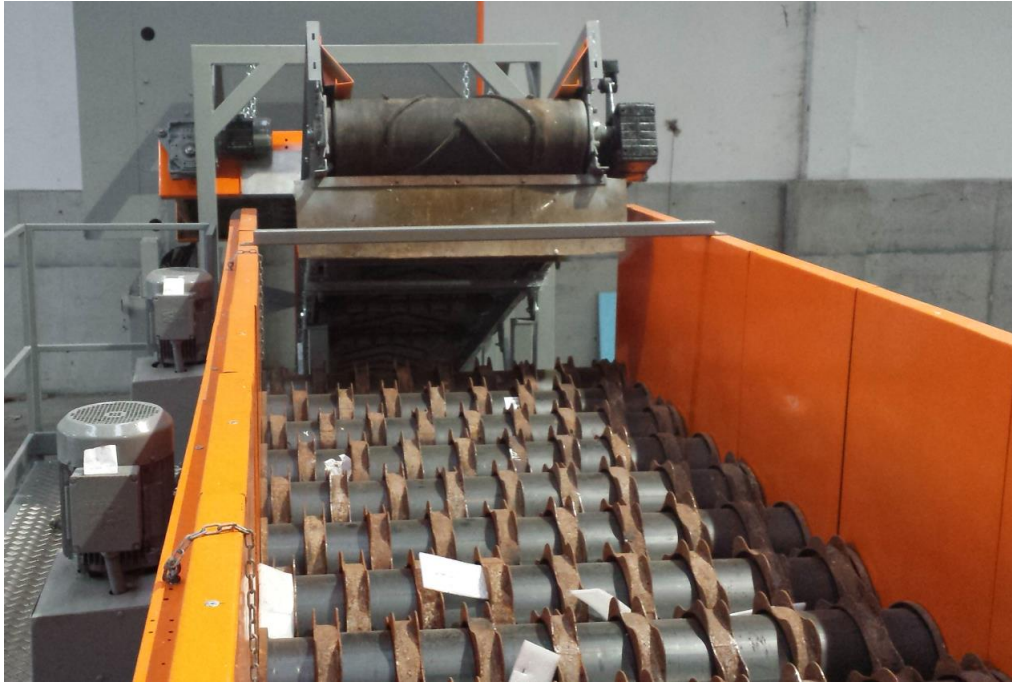
Foto 3. Vaglio a dischi della tipologia prevista nell'impianto in progetto.
