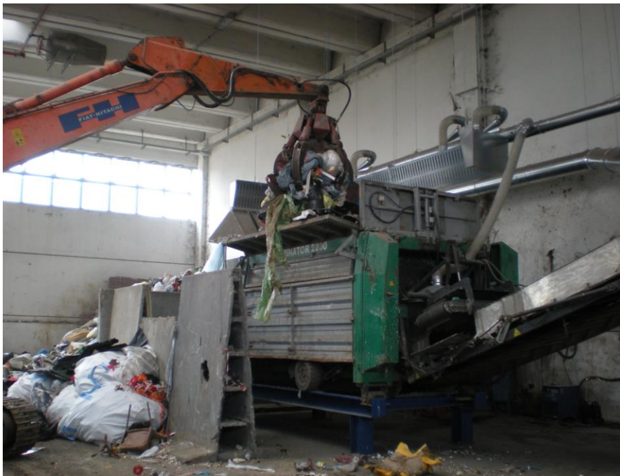
Foto 2. Il trituratore utilizzato
