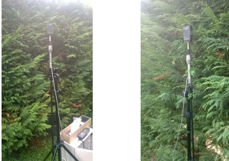
Foto n. 2 e 3 : calibrazione a inizio e fine delle misure (riferimento punto 2)
