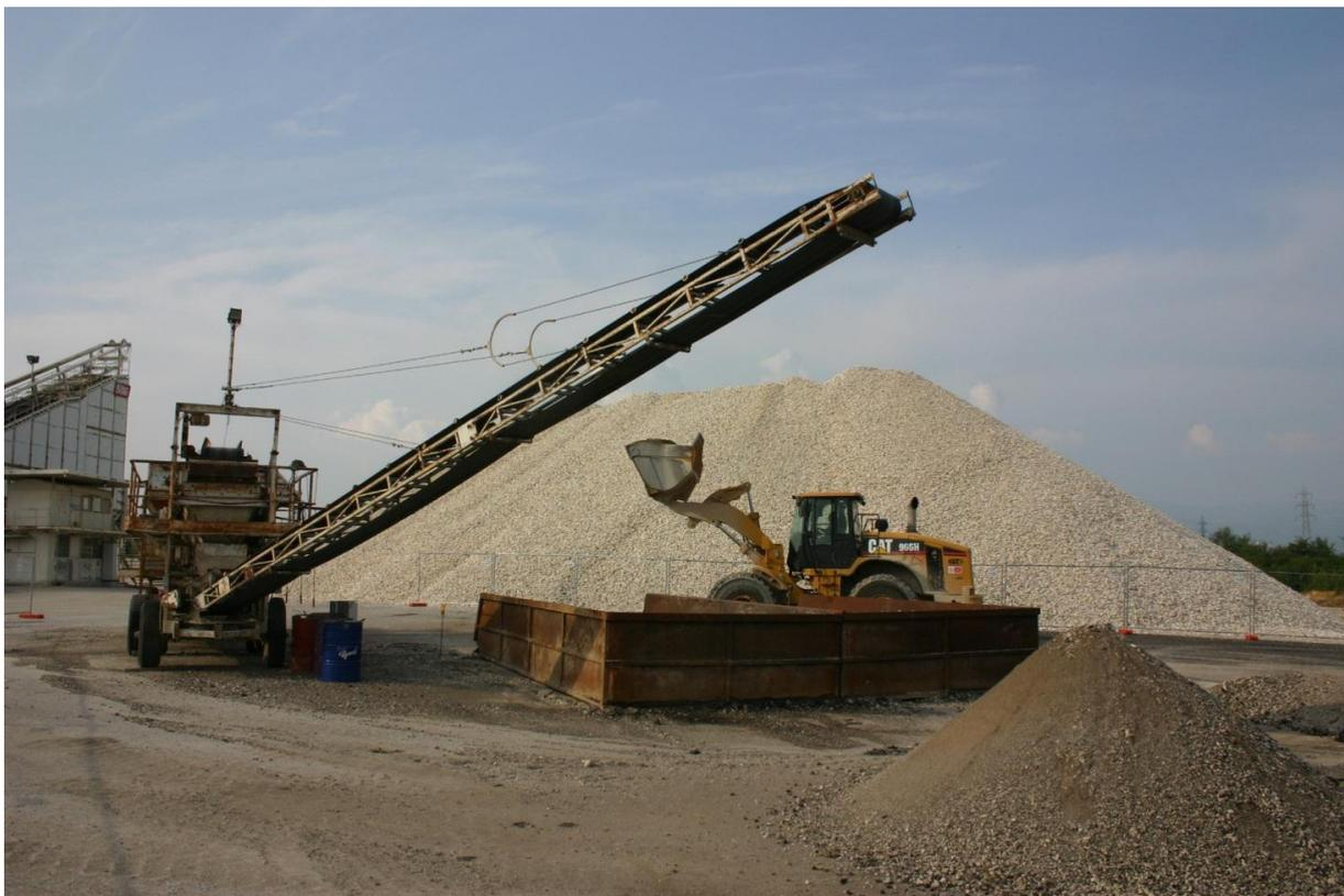
Figura 11. Interno del cantiere. Impianto trattamento rifiuti speciali non pericolosi e cassoni per la messa in riserva .
