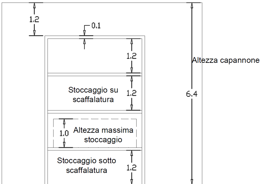
Figura 4. Altezza massima stoccaggio su scaffalatura
