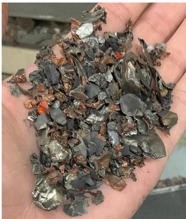
Figura 1. Esempio di rifiuto metallico derivante dalla macinazione dell'involucro batterie
