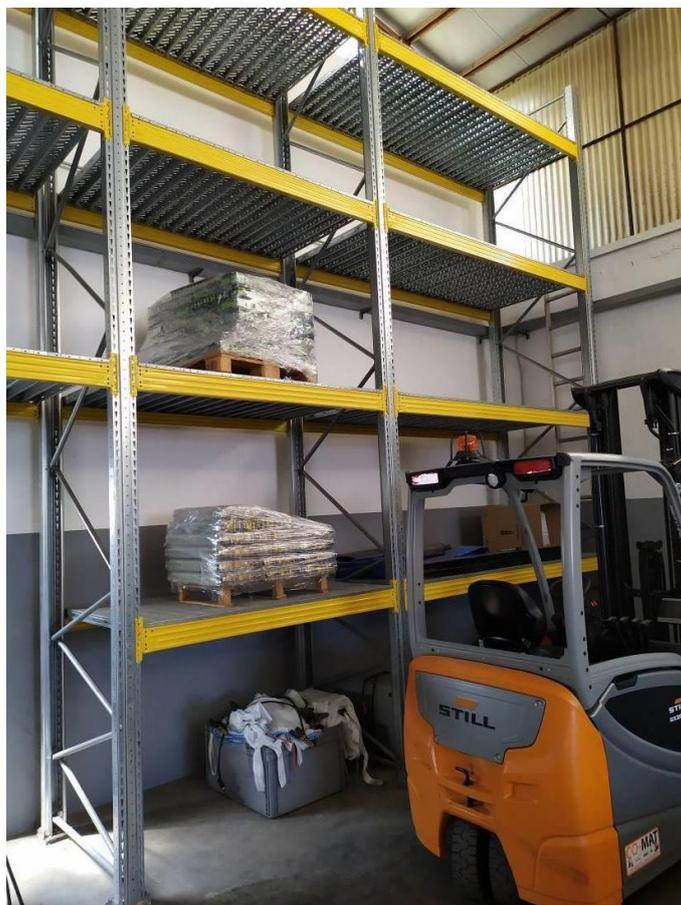
Figura 2. Scaffalatura per lo stoccaggio in area n.5 – batterie pericolose; verrà utilizzata anche l’area a terra sotto la scaffalatura (come da layout precedentemente inviato)
